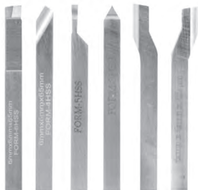
Рис. 1. Набір швидкорізальних різців для токарного верстата PROXXON
