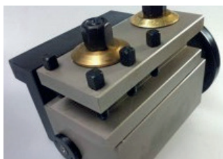
Рис. 19. Пристрій для обробки радіусів на токарному верстаті з ручним керуванням KD400
