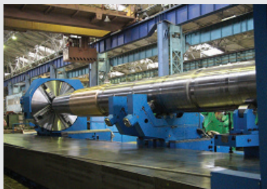
Рис. 2.16. Використання двох люнетів одночасно
