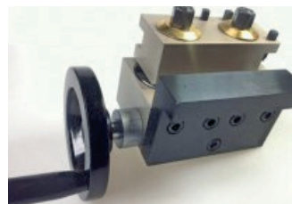
Рис. 19. Пристрій для обробки радіусів на токарному верстаті з ручним керуванням KD400
