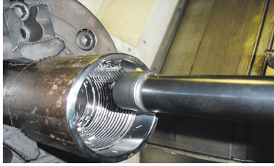
Рис. 7.35. Спеціалізований верстат для нарізування внутрішньої різьби та довбання повздожнього паза
