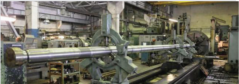
Рис. 2.17. Використання трьох люнетів одночасно
