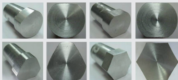
Рис. 5.6. Зразки деталей, отриманих методом полігонального точіння
