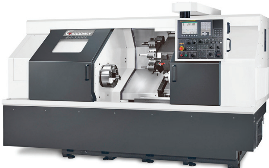
Рис. 7.18. Токарно-револьверний верстат з програмним керуванням з 12-позиційною револьверною головою
