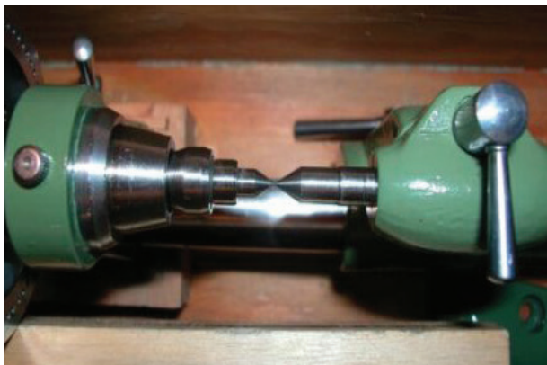
Рис. 11. Збіг конусів переднього і заднього центрів
