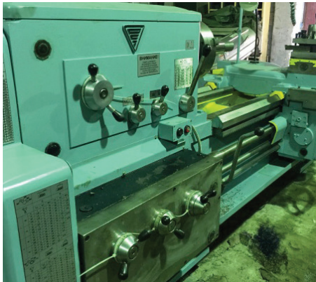
Рис. 2.1. Токарний верстат після капітального ремонту
