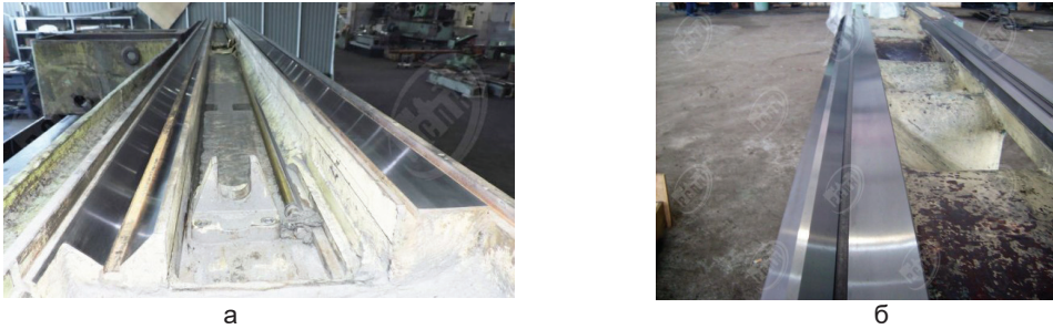
Рис. 3.2. Напрявні токарного верстата: а — до капітального ремонту; б — після капітального ремонту
