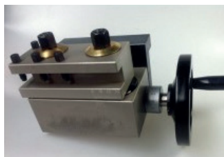
Рис. 19. Пристрій для обробки радіусів на токарному верстаті з ручним керуванням KD400
